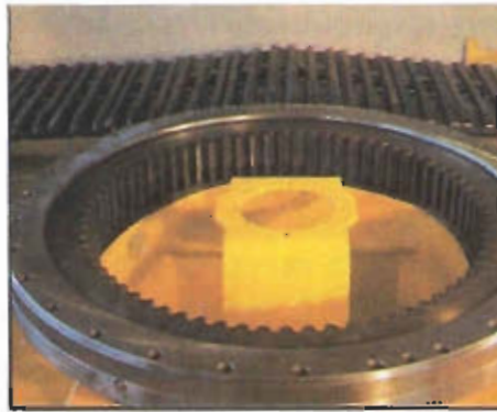
Опорно-поворотный круг с одним рядом перекошенных роликов
